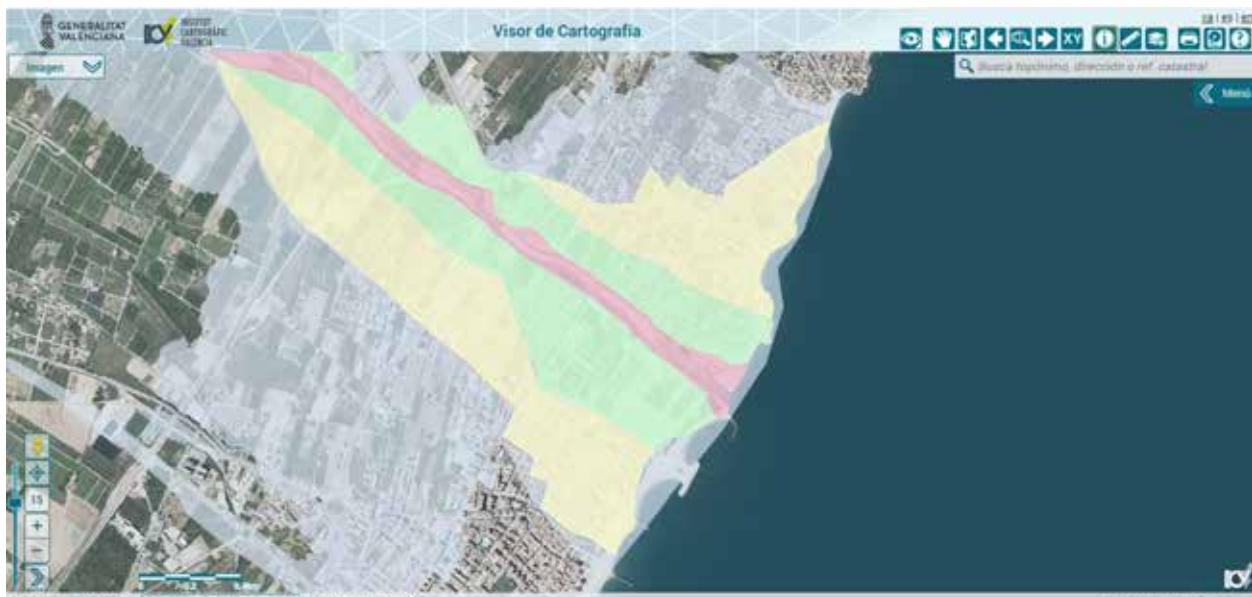
*PATRICOVA amb els riscos d'inundació en l'àrea de la desembocadura del Cervol. Roig: perillositat 1. Verd: perillositat 4. Groc: perillositat 6. Blau: envoltant de perillositat per inundació. Imatge: Institut Cartogràfic Valencià.*
